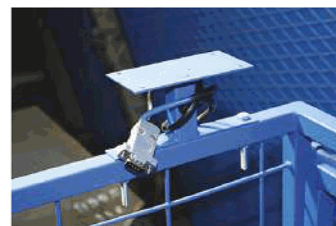
Кронштейн индикатора на ограждении
